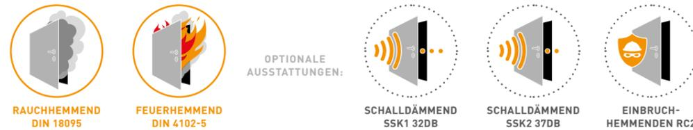
Mit KONOLD T30/RS-Brandschutzelementen, geprüft nach **DIN 4102-5 (Feuerschutz)** und **DIN 18095 (Rauchschutz)**, können Sie in diesem Bereich auf den größtmöglichen Schutz zählen.
